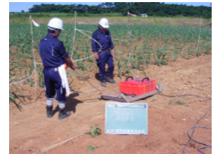
空洞調査 (地下レーダ)
